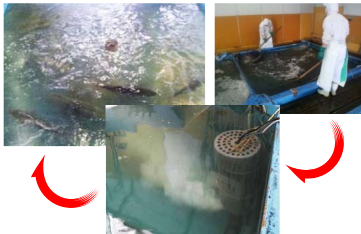
水中ポンプ投込み式の微細気泡発生器を投入することで手軽に溶存酸素を補給できる。
